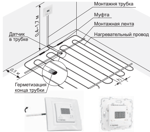
Рисунок 1. Монтаж терморегулятора и системы теплый пол
